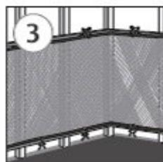
Netz straff spannen! · Stretch the net tightly! · Tendre
